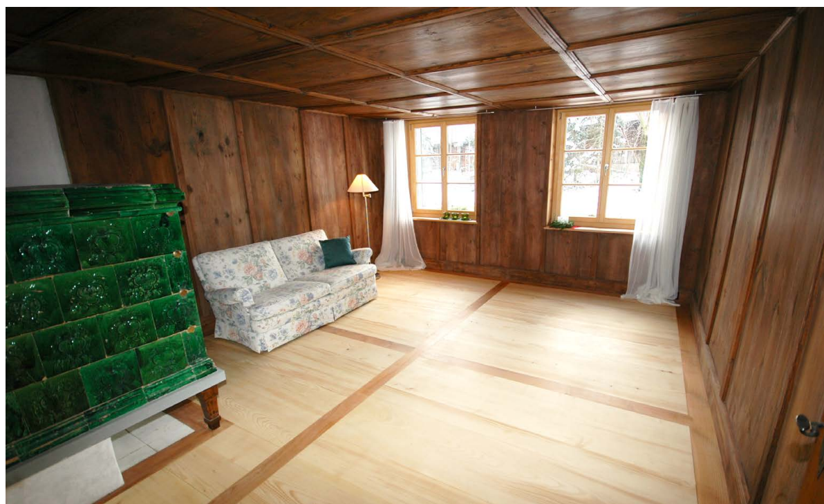
Salon d'une ferme à Frauenfeld, env. 1680. Travaux de restauration: le plafond en bois et les boiseries (parois) ont été démontés pendant la période de construction, et reposés une fois nettoyés et restaurés. Le sol d'origine a été complété. Photo: Hanspeter Strang.
